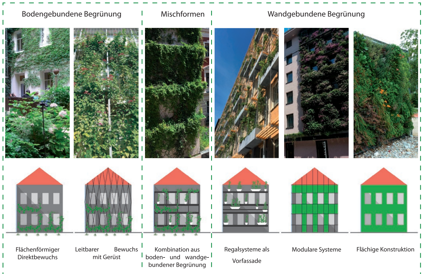
Abb. 10: Die Arten der Fassadenbegrünung (Quelle: GRÜNSTATTTGRAU eigene Erstellung)
