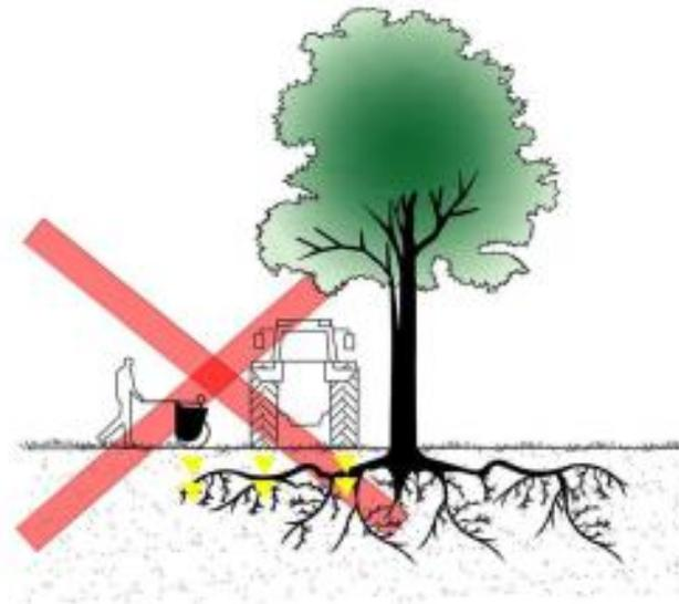
Bild 5 — Vermeidung von Bodenverdichtung durch das Befahren mit Geräten und Maschinen
