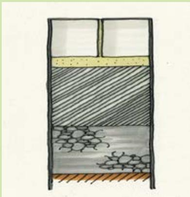
Pflastersteine (Fugenverguss mit Zementmörtel)
